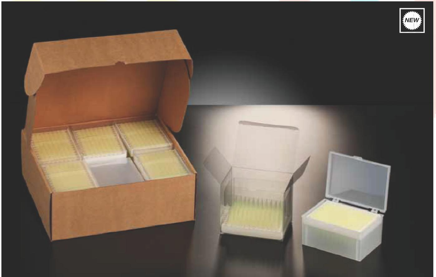
I nostri rack sono Prodotti in polipropilene **autoclavabile**, e sono stati sviluppati secondo un codice colore identificativo: rack con puntali senza filtro sono blu o di colore traslucido, dipende dal codice; rack con puntali con filtro sono di colore rosso e rack con extra filtro sono bianchi .
