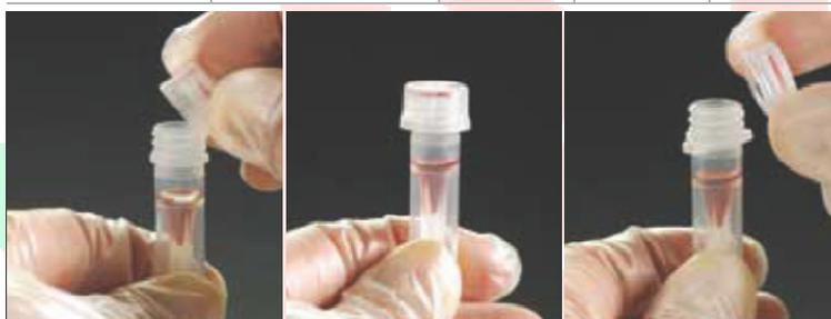
Inserimento del tappo a vite fino al blocco a scatto dell'anello sul collo seghettato della provetta.
